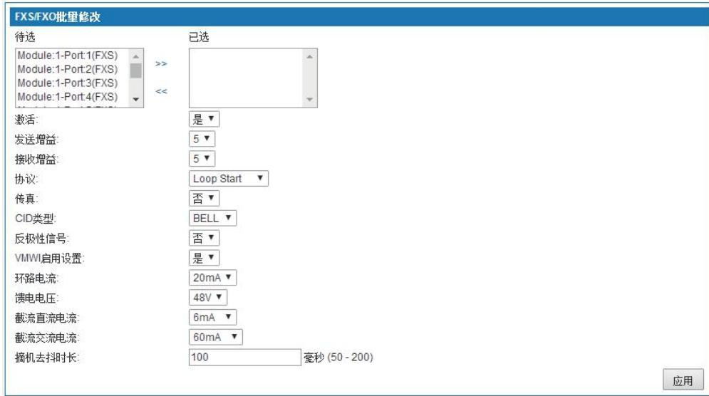
图 6-128 模拟接口配置-FXS/FXO 批量修改
