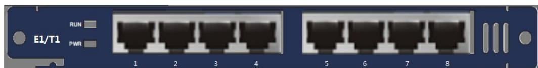
图 1-5 IP PBX8000 8E1/T1 数字中继板外观图
