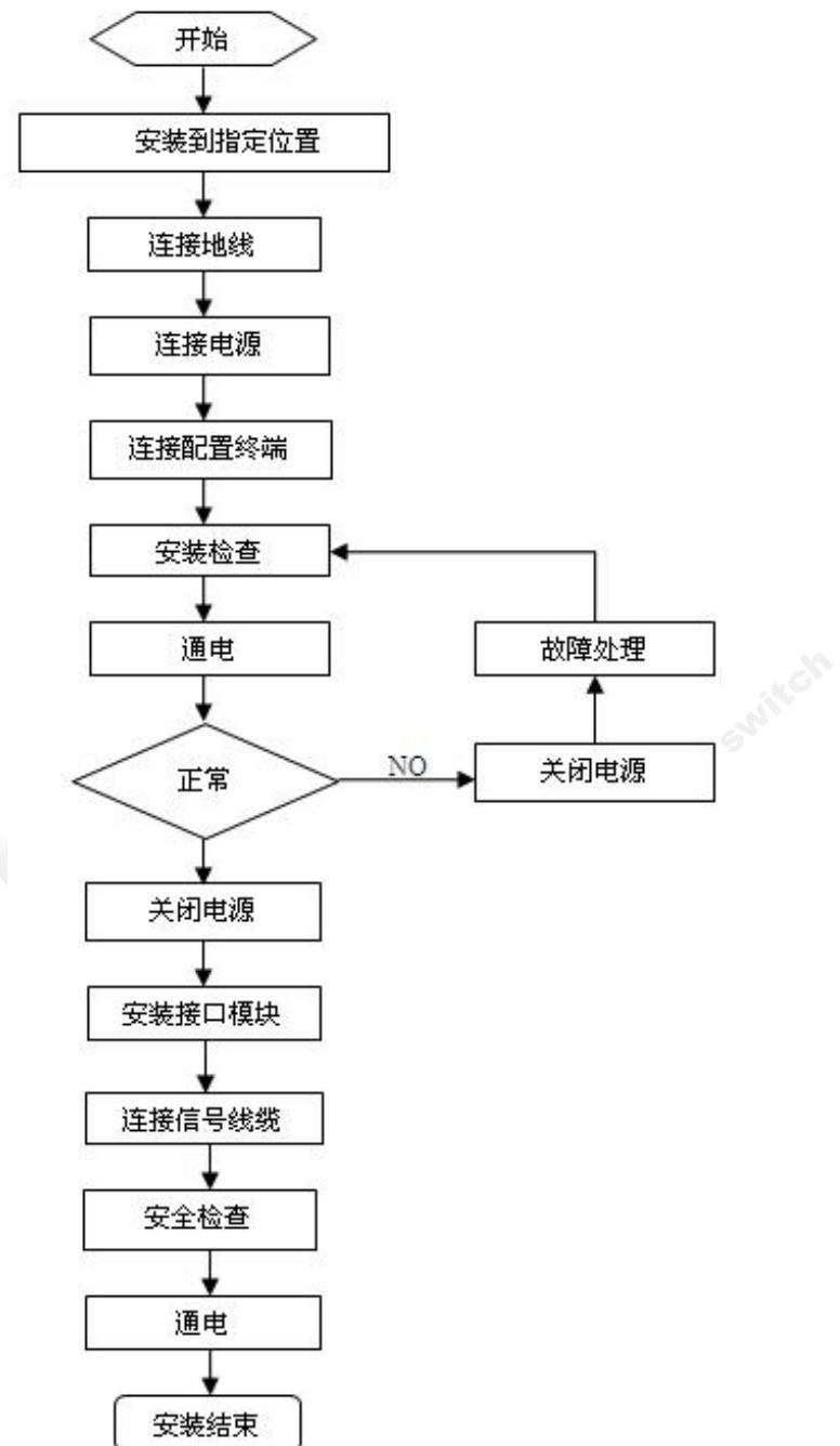
图 2-1 设备安装流程
