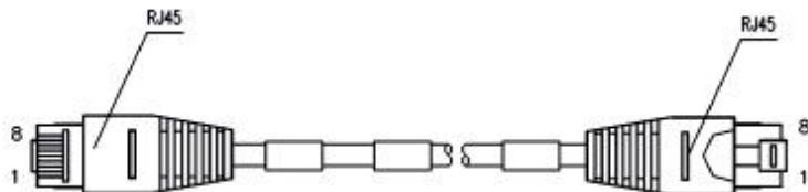
图 2-3 以太网电缆示意图
