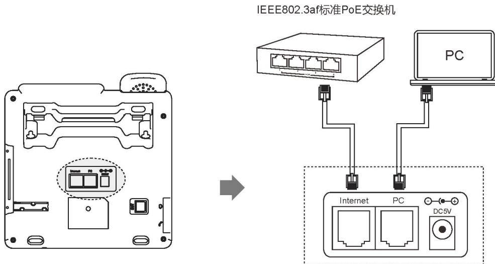
**说明** 若使用PoE供电请确认你的话机和交换机是否支持PoE供电，使用PoE供电则不需要再连接适配器供电，如需帮助请联系你的网络管理员或经销商进行确认。
