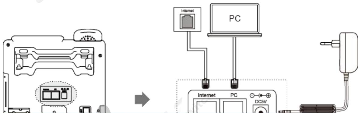
**说明** 所使用的适配器电压不能高于5V  $\equiv$  1A, 以免造成话机芯片的损坏。关于话机的安全使用请阅读[安全使用须知](#)。
