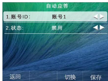
话机开启自动应答后，话机待机的显示界面出现自动应答图标
