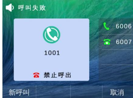
号码，当你呼叫的号码与规则匹配时，话机液晶显示屏上将显示“禁止号码”字样。
