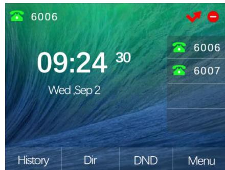
话机待机界面可以显示话机的时间、日期、话机的状态（免打扰、自动接听）、账号的注册状态、分机号码、标签，以及液晶显示屏底部的四个软键（**话单**、**话簿**、**免扰**、**菜单**）的标签。待机界面的图标说明请参考[显示屏图标组成](#)。
