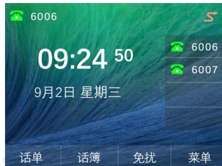
**说明** 如果已经事先设置了呼叫转移功能，可以通过话机面板上的transfer按钮快速开/关呼叫转移。
