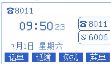
话机待机界面可以显示话机的时间、日期、话机的状态（免打扰、自动接听）、账号的注册状态、分机号码、标签，以及液晶显示屏底部的四个软键（**话单**、**话簿**、**免扰**、**菜单**）的标签。待机界面的图标说明请参考[显示屏图标组成](#)。
