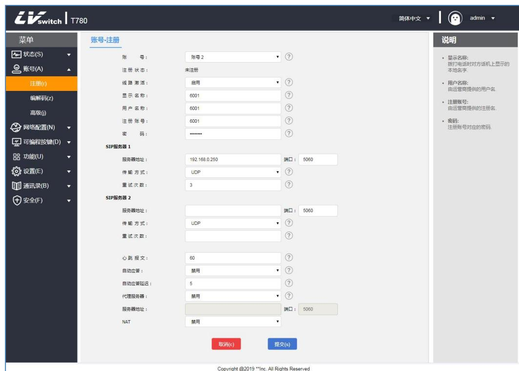
**说明** 如果出现话机无法注册的问题，请检查注册的信息是否填写正确，检查话机的网络是否正常，如需帮助，请联系你的网络管理员。
