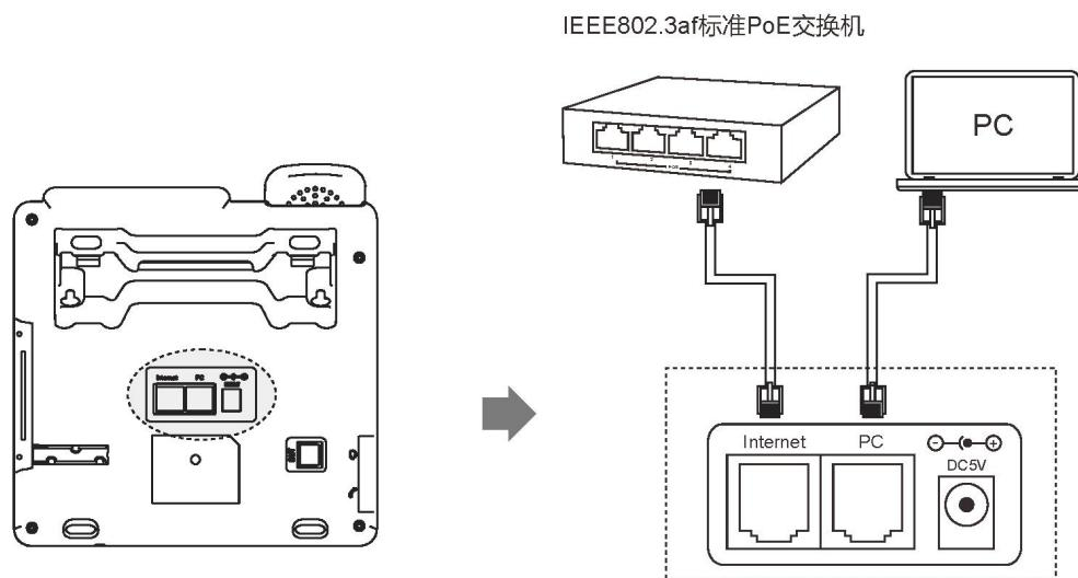
**说明** 若使用PoE供电请确认你的话机和交换机是否支持PoE供电，使用PoE供电则不需要再连接适配器供电，如需帮助请联系你的网络管理员或经销商进行确认。
