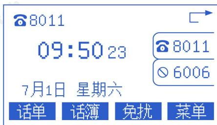
**说明** 如果已经事先设置了呼叫转移功能，可以通过话机面板上的transfer按钮快速开/关呼叫转移。
